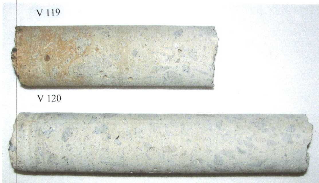
Obr. 1.: Vývrty z betonu po dodání do laboratoře - první skupina
